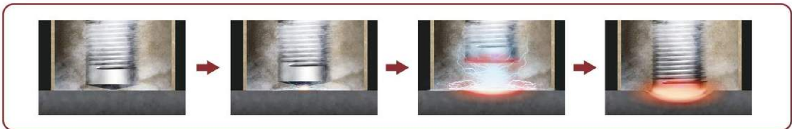
气体保护焊接过程/ Gas stud welding process
